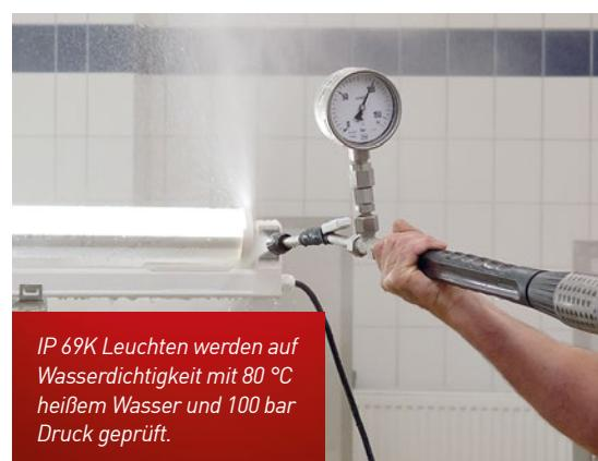
*IP 69K Leuchten werden auf Wasserdichtigkeit mit 80 °C heißem Wasser und 100 bar Druck geprüft.*
