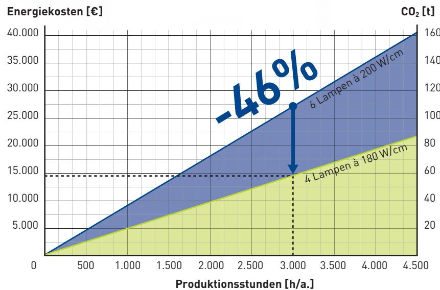
Das Diagramm zeigt, in Abhängigkeit der elektrischen Anschlussleistung, die Energiekosten und den CO<sub>2</sub>-Ausstoß (gemäß deutschem Energiermix), sowie das Einsparpotenzial des aktuellen BLK LAMPcure verglichen mit BLK-2 – bezogen auf die gesamte UV-Anlage pro Jahr. Bei der Berechnung wurde von einer Stand-by-Zeit von 20 Prozent und einem Strompreis von 0,12 €/kwh ausgegangen.
